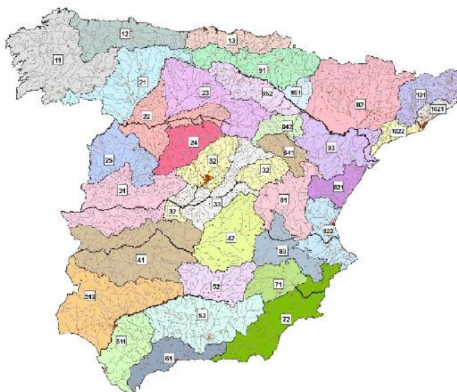
Figura 4 Regiones para la caracterización del coeficiente corrector del umbral de escorrentía (Fig 2.9 de la Norma 5.2-IC)
