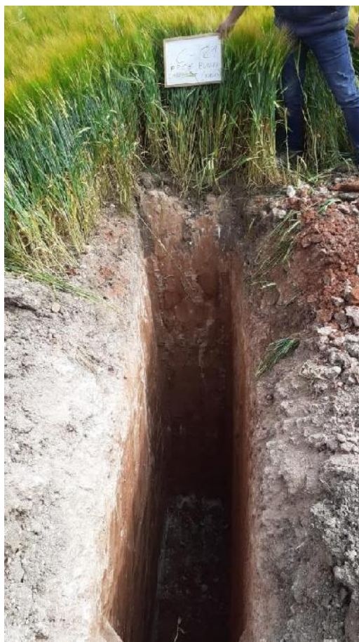
Figura 7 Excavación de calicatas
