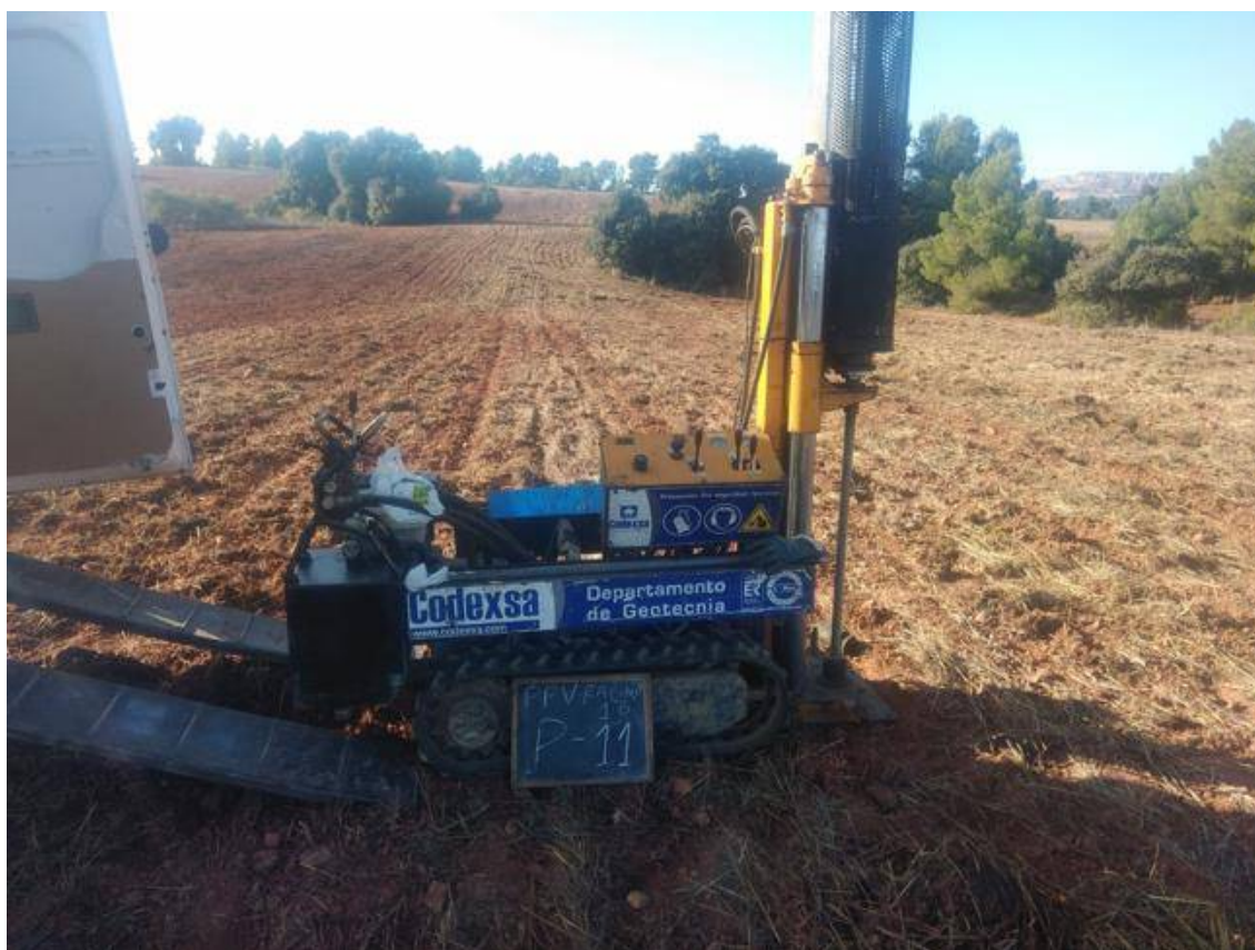
Figura 13 Maquinaria ensayos de penetración DPSH
