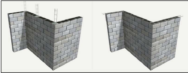
NUEVO MURO MEDIANERO DE BLOQUE DE HORMIGÓN ARMADO DE 20cm, CON ARRANQUE DE 25cm. CON ESTE CERRAMIENTO SE CONSIGUE LA RESISTENCIA Y ESTABILIDAD AL FUEGO EI 120 EXIGIDA.
