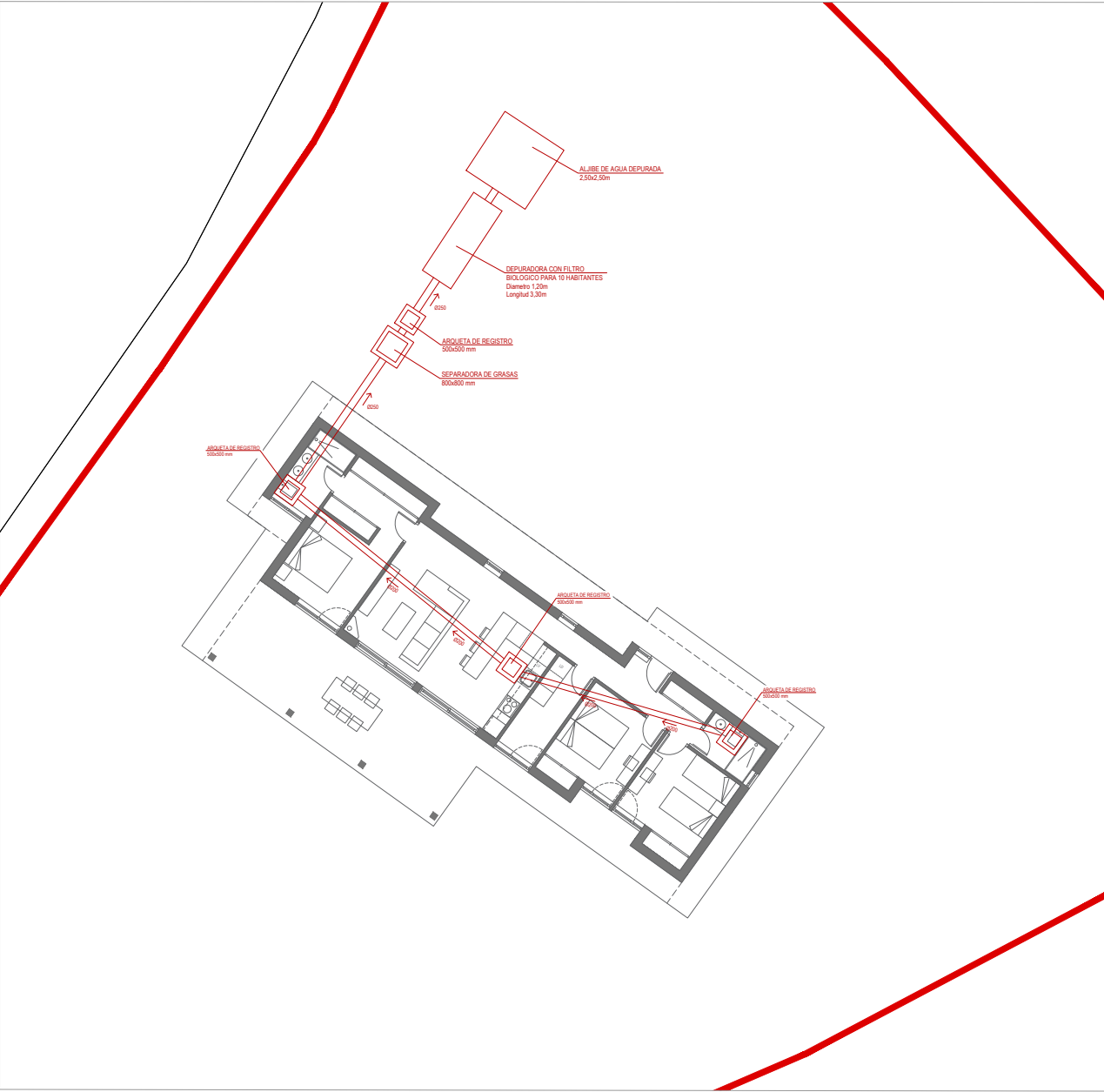
ESQUEMA DE FUNCIONAMIENTO DE INSTALACIÓN DE LA DEPURADORA.
