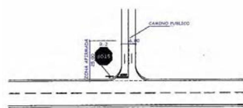
La geometría del enlace se proyecta de acuerdo con la Guía de Nudos Viarios de la Orden Circular 32/2012 y las Recomendaciones para el proyecto de intersecciones de la Dirección General de Carreteras, para el caso de intersección sin canalizar y vehículo tipo C (camiones), de acuerdo con el artículo 56.1 de la Orden de 16 de diciembre de
