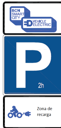
Figura 17: Señalización vertical colocada al inicio de la zona de recarga eléctrica a 60cm de la acera
