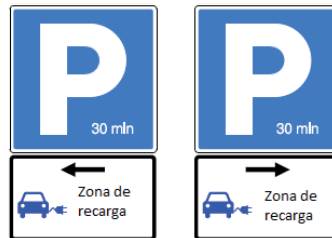
Figura 13: Señalización vertical colocada al inicio de la zona de recarga eléctrica a 60cm de la acera
