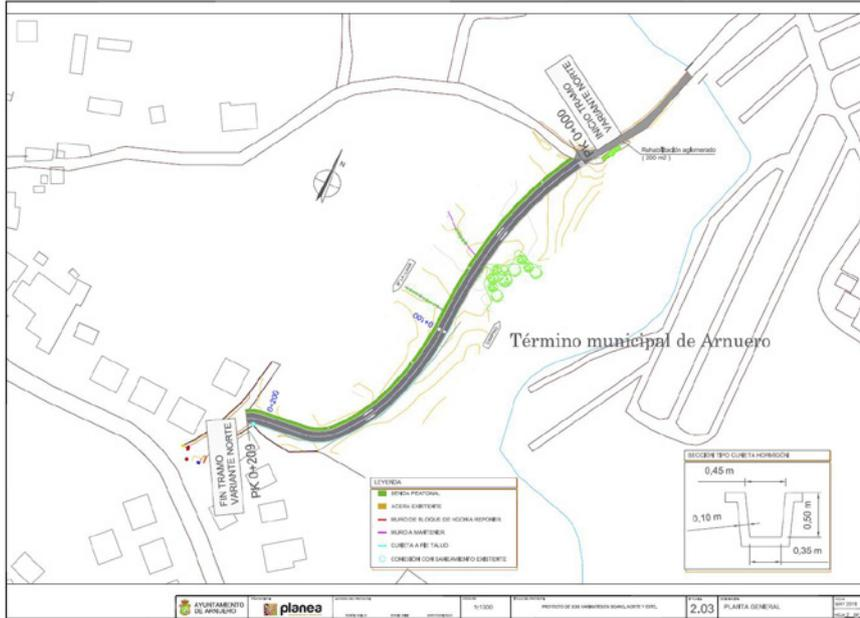
Figura 6. Plano de PLANTA GENERAL de la variante norte de Soano. Proyecto de Ejecución de dos variantes al este y al norte de Soano.
