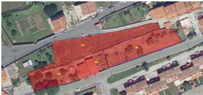
La singularidad de la parcela por su geometría en planta como la topografía existente, con cerca de 6m de diferencia aproximadamente entre rasantes de alineaciones norte y sur, suponen un condicionante para la implantación de las edificaciones futuras a desarrollar.
